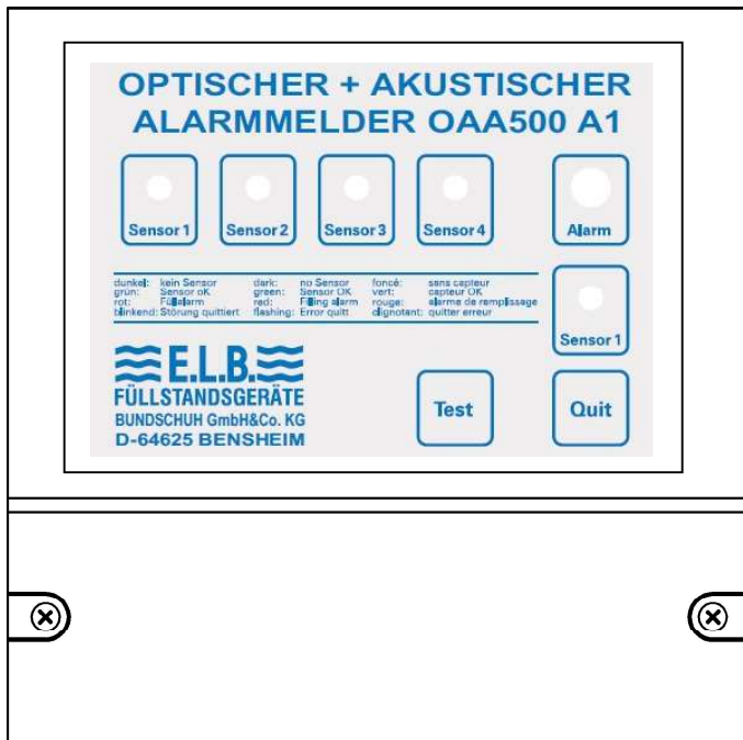
Gehäuseabmessung: 137 mm x 186 mm (ohne Kabelverschr.) x 103 mm
